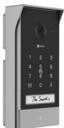
Panel interkomu (domovního zvonku) s krytem proti povětrnostním vlivům (1×)
